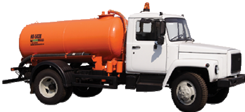
Рисунок 8.3.1. Вакуумная машина КО-503В
