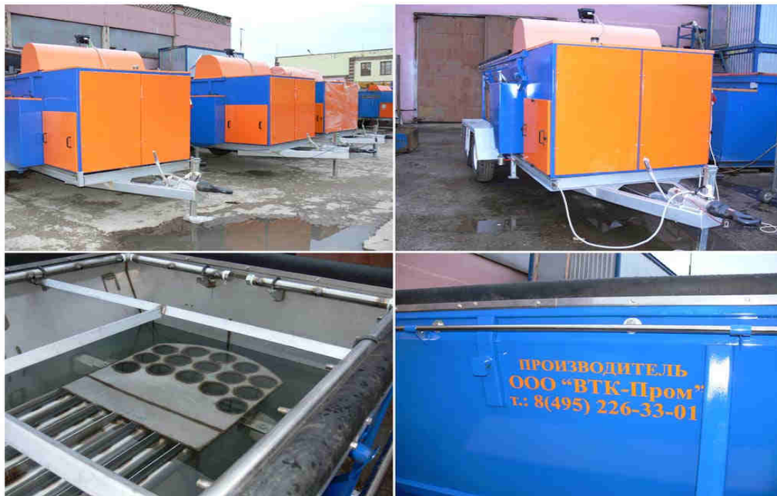
Рис.8.4.2. Мобильная снегоплавильная установка
