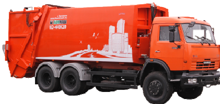
Рисунок 8.1.1 Мусоровоз с задней загрузкой КО-440К20
