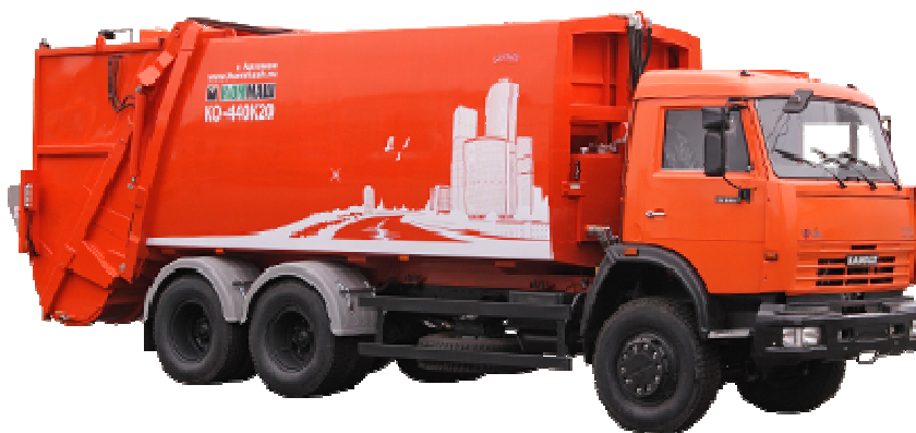
Рисунок 8.1.1 Мусоровоз с задней загрузкой КО-440К20
